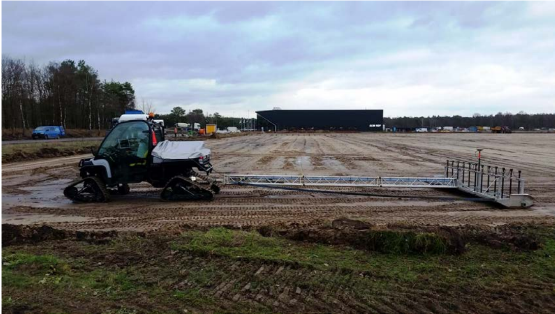
Figuur 3: Detectievoertuig Gator met meetslee.
