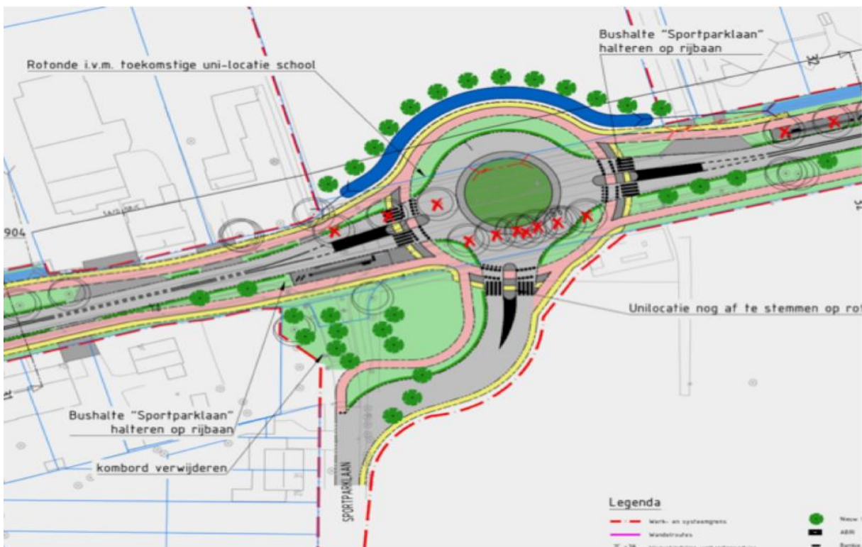
Aanleg rotonde en aansluiting op Sportparklaan
